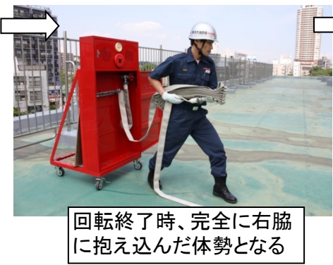
駆け足でホースを抱えたまま延長していく。後に引かれ、折りたたまれているホースの上側から後方に落ちていくので※一度に3分の1以上が落ちないように延長します
